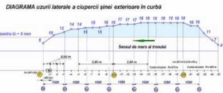
Fig. nr.3 – Diagrama uzurii ciupercii șinei exterioare în curbă
