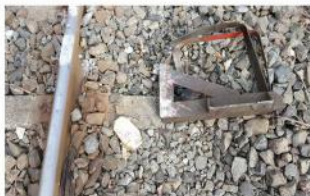
Imaginea 5 - suportul căzut al rezervorului de motorină de la vagonul remorcă LVS 538
