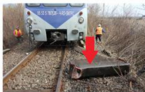
Imaginea 6 - rezervorul căzut de la vagonul remorcă LVS 538
