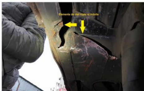
Imagina 9 – deformări mecanice ale elementelor de șasiu, provocate de un corp solid care a exercitat o forță de jos în sus asupra șasiului
